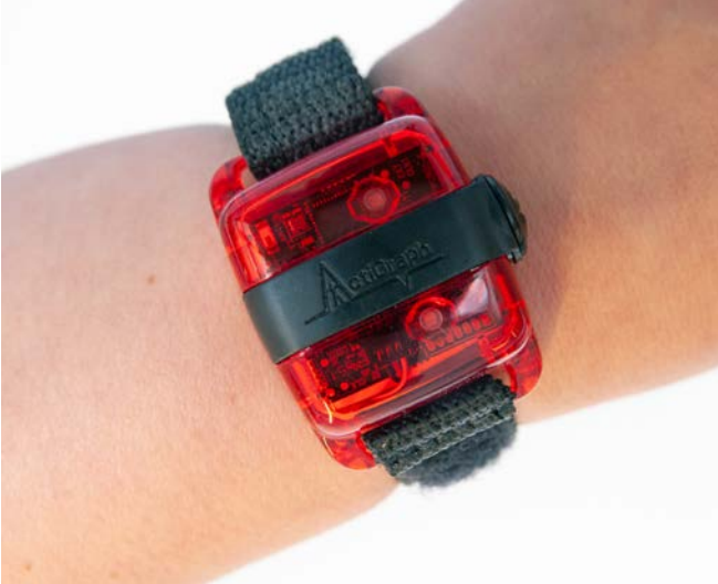
Abb. 1 Der Aktigraph ist ein Messgerät zur Erfassung der Bewegungsaktivität, das wie eine Armbanduhr am Handgelenk Tag und Nacht getragen wird. Mit den erhobenen Daten können dann Aktivitäts- und Ruhezeiten der Person analysiert werden.
